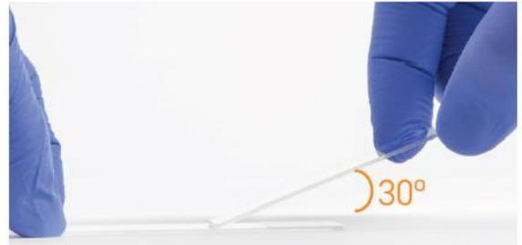
3. Une "ligne" d'échantillon doit se former au bord de la deuxième lame une fois qu'elle est dans la bonne position.
